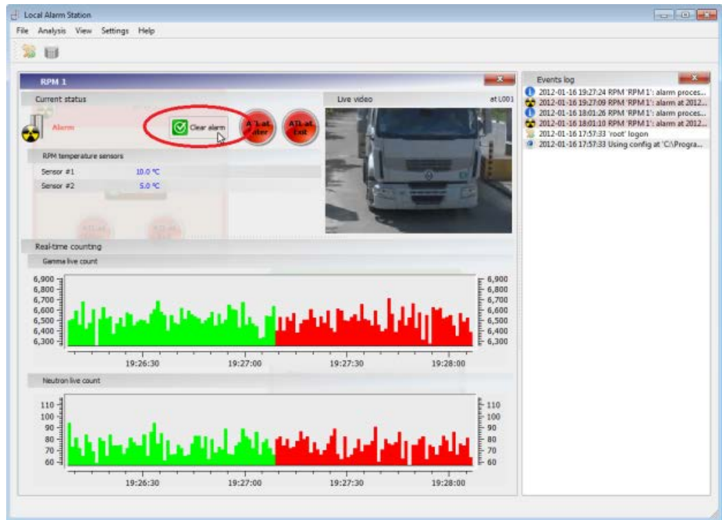
Gambar 10. Tampilan pada Monitor CAS jika RPM mengaktifkan sinyal alarm
