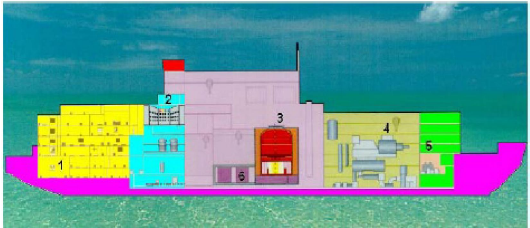
Gambar 3 Tata letak (Layout) kompartemen di dalam tongkang PLTN terapung berbasis KLT-40s yang terdiri dari kompartemen hunian (1), ruang kendali utama(2), kompartemen reaktor (3), kompartemen turbin(4), kompartemen kelistrikan (6) [2]
