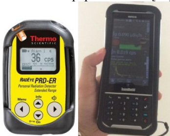
Gambar 1a dan 1b. Personal Radiation Detector (PRD) dan Portable Radiation Scanner (PRS) bagian dari backpack
