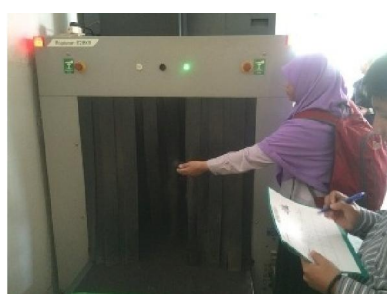
Gambar 4b. Proses Pengukuran Pemindai Barang Bagasi Hotel
