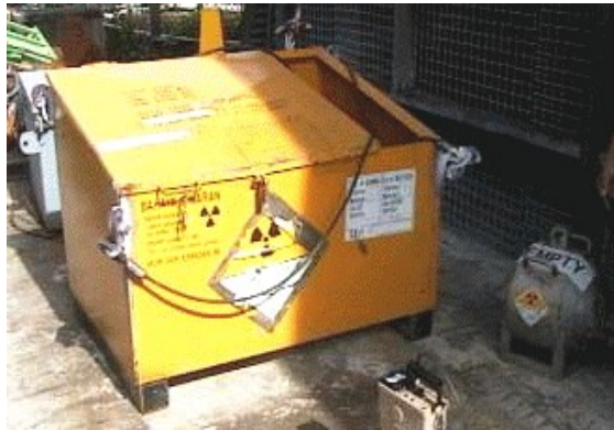
Gambar 10. Bungkus luar ( overpack ) dalam pengangkutan zat radioaktif
