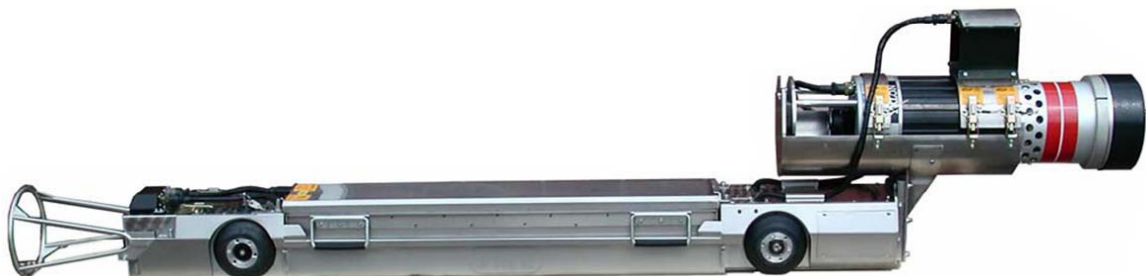
Gambar 3. Unit perangkat ( crawler ) industri menggunakan tabung sinar-X
