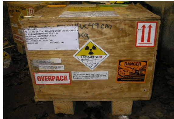
Gambar 10. Bungkus luar ( overpack ) dalam pengangkutan zat radioaktif
