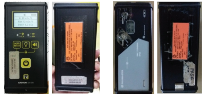
Gambar 1. Dosemeter yang digunakan untuk pemetaan gamma di RSG-GAS (a) Radion SR-5M (b) Polimaster PM171GGMA
